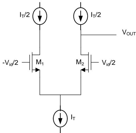
$$A_V = -\frac{g_{m1}}{2g_0} = \frac{2I_{DQ}/V_{EB1}}{2\lambda I_{DQ}}$$
