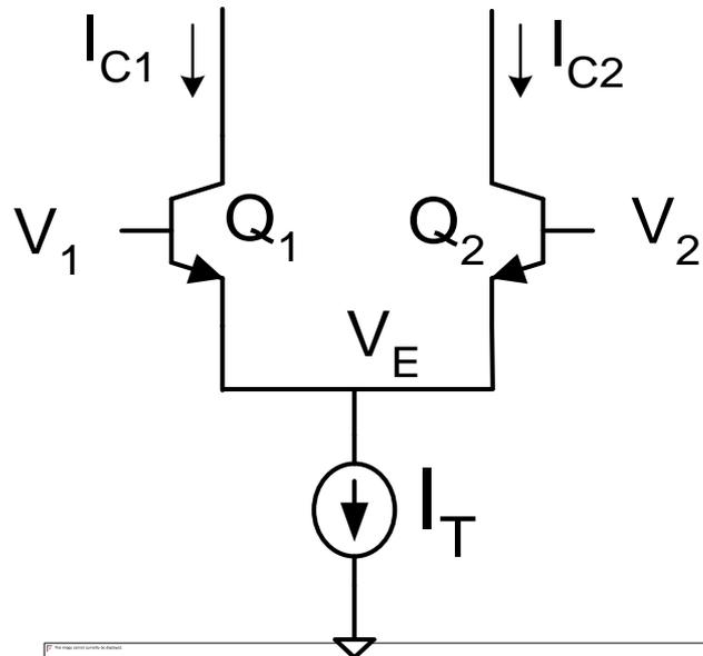
$$V_d = V_2 - V_1$$
