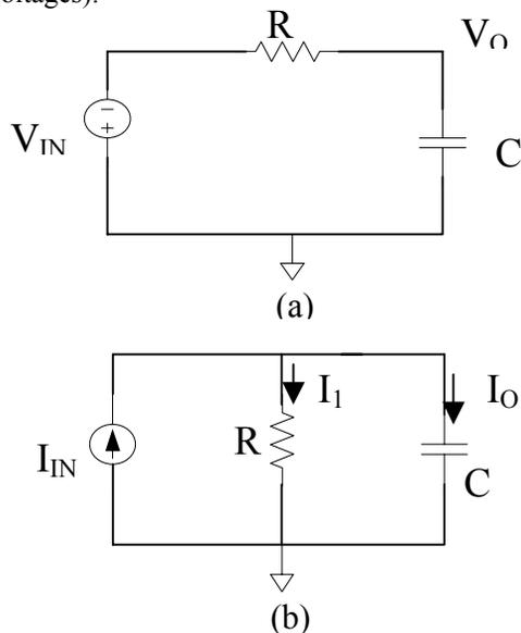
Fig. 1 A simple RC Circuit a) Voltage-Mode, b) Current-mode
